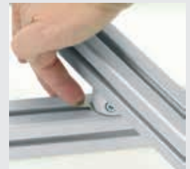
Demontage: Nach dem Lösen der Spannschraube wird das Riegelblech aus der Profilnut gehoben und zurückgeschwenkt. Der KLICK-Verbindungssatz muss nicht zerlegt werden und ist sofort wieder für den nächsten Einsatz bereit.
