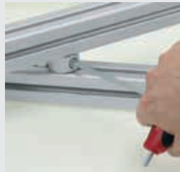
Ausrichten des KLICK-Verbindungssatzes und Anziehen der Spannschraube
