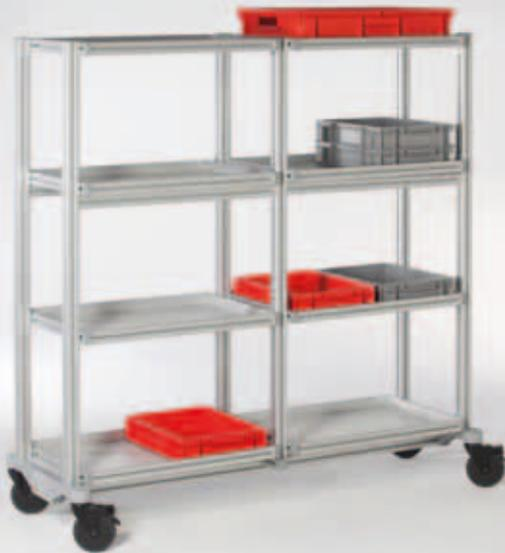
Wenn es um das Bewegen großer Lasten oder vieler Werkstücke geht, sind SystemMobile U die beste Wahl. Außen angeordnete vertikale Streben leiten die Kräfte direkt in die Rollen. Dadurch lassen sich die robusten Transportwagen im beladenen Zustand kipp sicher bewegen.
