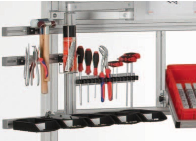
Der Werkzeughalter 8 kann an beliebiger Stelle in die Profilnut 8 eingesetzt werden. Seine federbelasteten Elemente aus flexiblem Kunststoff umklammern eingeschobene Werkzeuge. Für die Aufnahme einer größeren Anzahl von Werkzeugen lassen sich die Werkzeughalter 8 beliebig anreihen.
