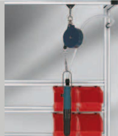
Den item Werkzeugschlitten gibt es in zwei Bauformen: zum Einschieben in die Profilnut 8 mit 50 N Tragkraft oder als Werkzeugschlitten 8 80x40 mit integrierten Gleitsätzen und einer Tragkraft von 200 N. In beiden Fällen wird Zubehör über einen stabilen Karabinerhaken angeschlossen.
