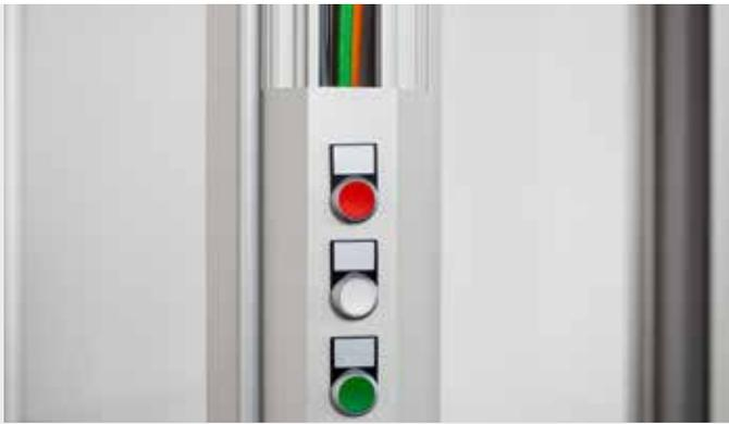
Steuer- und Bedienelemente können direkt auf der Außenseite der Maschinenkabine integriert und mit den Leitungen im Kabelkanal verbunden werden.
