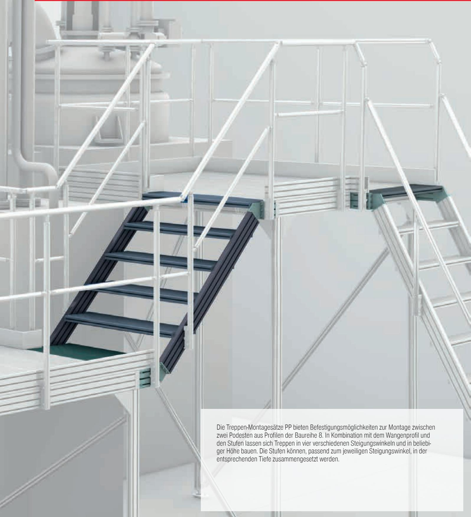
Die Treppen-Montagesätze PP bieten Befestigungsmöglichkeiten zur Montage zwischen zwei Podesten aus Profilen der Baureihe 8. In Kombination mit dem Wangenprofil und den Stufen lassen sich Treppen in vier verschiedenen Steigungswinkeln und in beliebiger Höhe bauen. Die Stufen können, passend zum jeweiligen Steigungswinkel, in der entsprechenden Tiefe zusammengesetzt werden.
